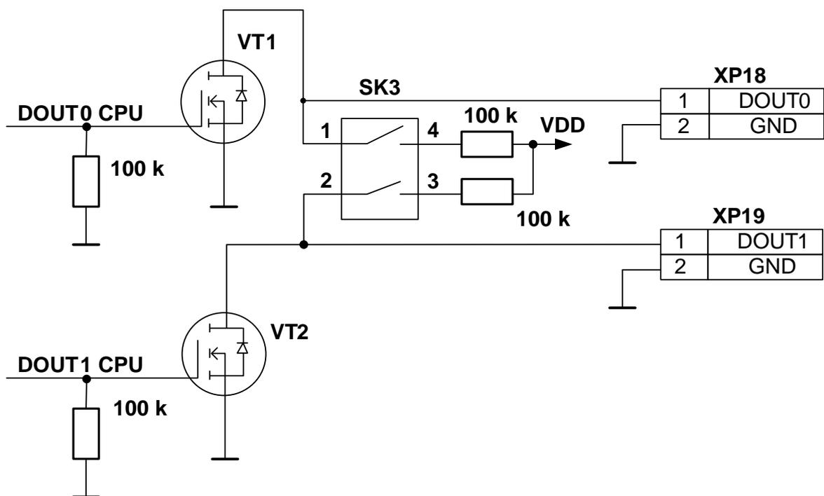
**Рис.Б.4. Схема окончных каскадов дискретных выходов модуля обработки данных ИВК исполнения ИВК-102.**
