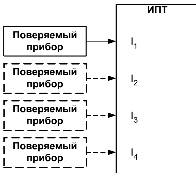
Рис.13. Схема сопряжения поверяемых приборов с ИПТ.
