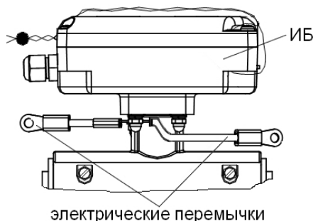
Рис.10. Электрические перемычки на ИБ расходомера.
