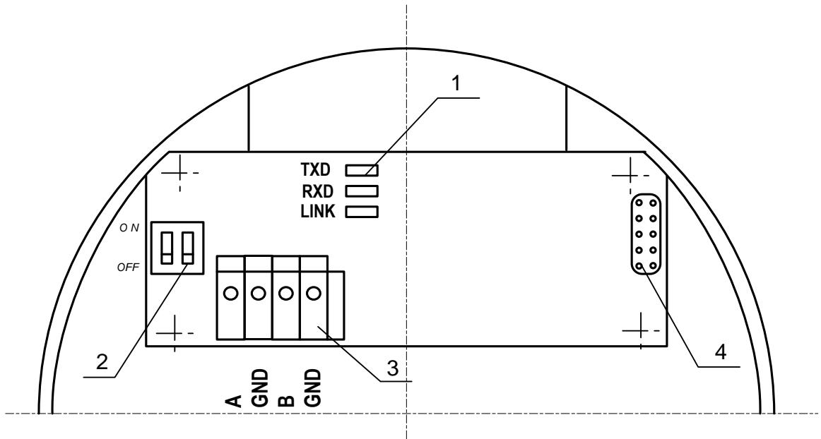
1 – светодиоды; 2 – переключатель терминалов; 3 – контактная колодка для подключения кабеля интерфейса Profibus; 4 – технологический разъем.
