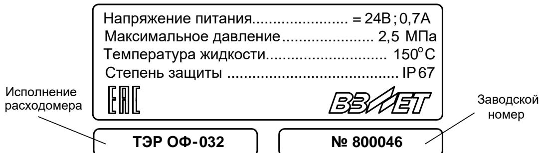
Рис.3. Вид шильда расходомера в едином конструктиве.
