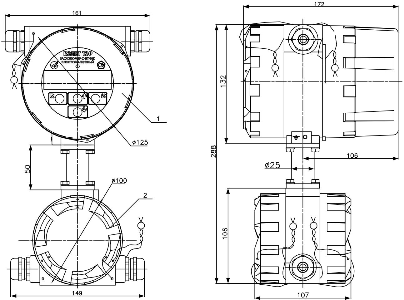
1 – блок электроники; 2 – блок коммутации.
