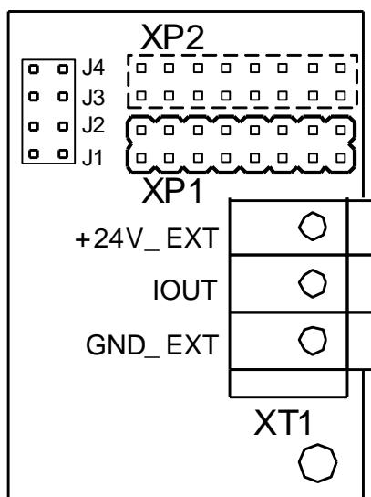
XP1 – колодка подключения шлейфа связи с модулем индикации;
