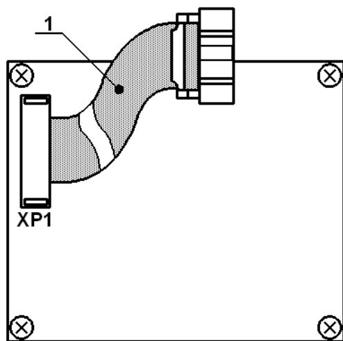
1 – шлейф связи с модулем обработки;
