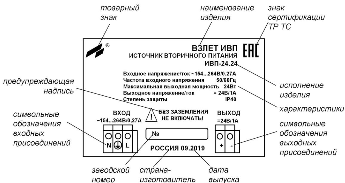
Рис.1. Маркировка ИВП в металлическом корпусе со степенью защиты IP40.
