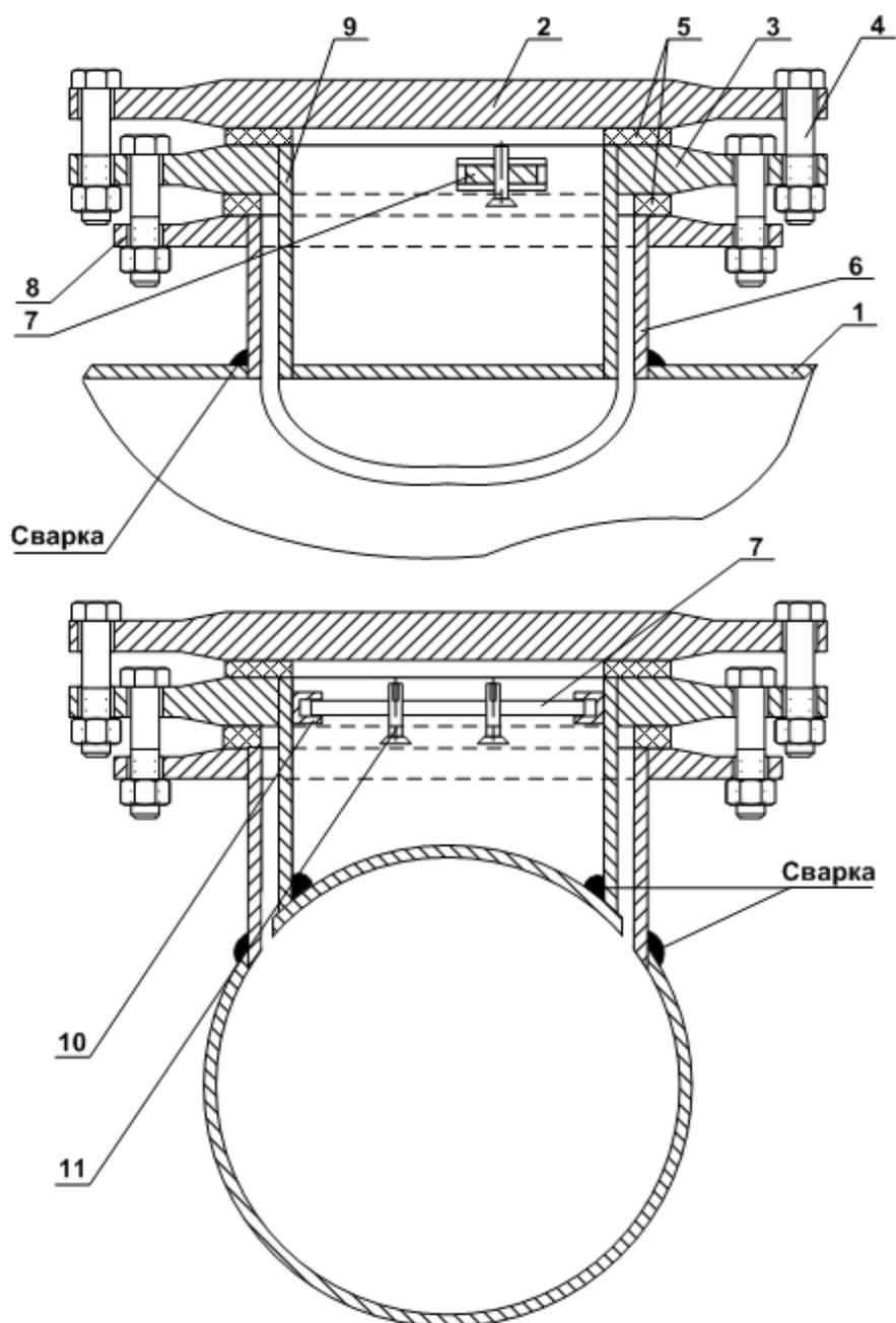
1 – трубопровод; 2 – крышка внутреннего стакана; 3 – фланец внутреннего стакана; 4 – крепежный болт; 5 – кольцевая прокладка; 6 – наружный стакан; 7 – планка крепления ПЭА; 8 – фланец наружного стакана; 9 – внутренний стакан; 10 – держатель планки крепления ПЭА; 11 – винт крепления ПЭА.
