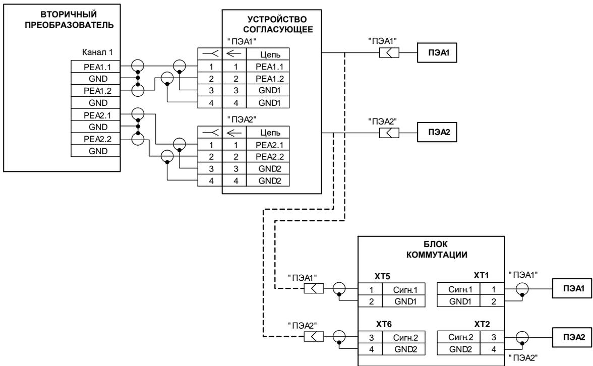
Рис.Г.3. Схема подключения пары ПЭА при симметричной схеме связи.
