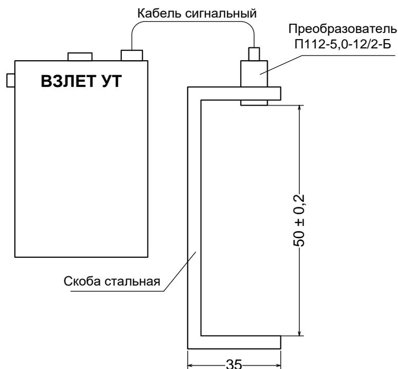
**Рис.Ж.1. Приспособление для измерения скорости ультразвука в жидкости.**
