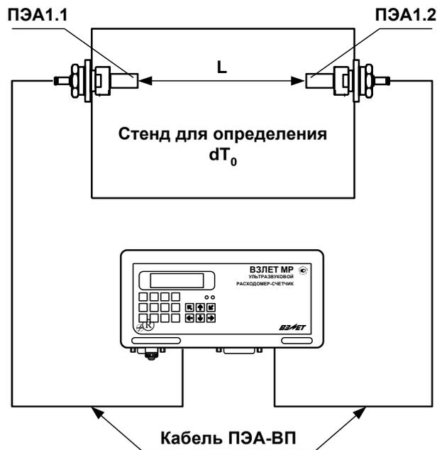
Рис.К.1. Определение смещения  $dT_0$  с помощью стенда.
