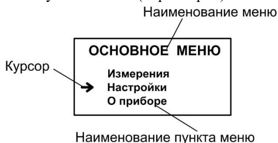
Рис.5 - Вид основного меню расходомера.
