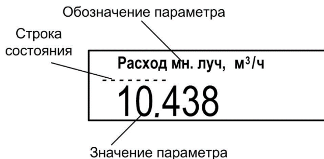
Рис.6 - Вид окна укрупненной индикации измеряемого параметра.
