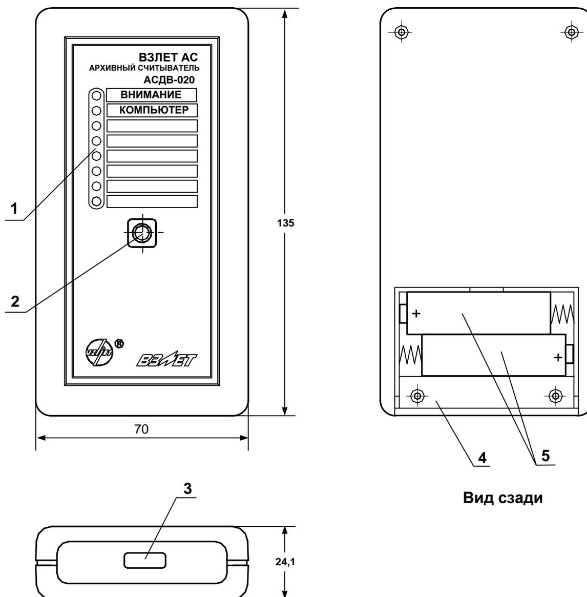
1 – светодиодные сигнализаторы; 2 – кнопка управления;
