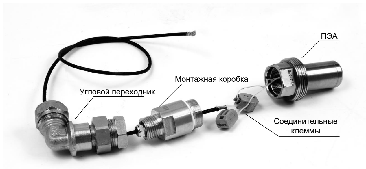
Рис.А.7. Патрубки монтажные.
