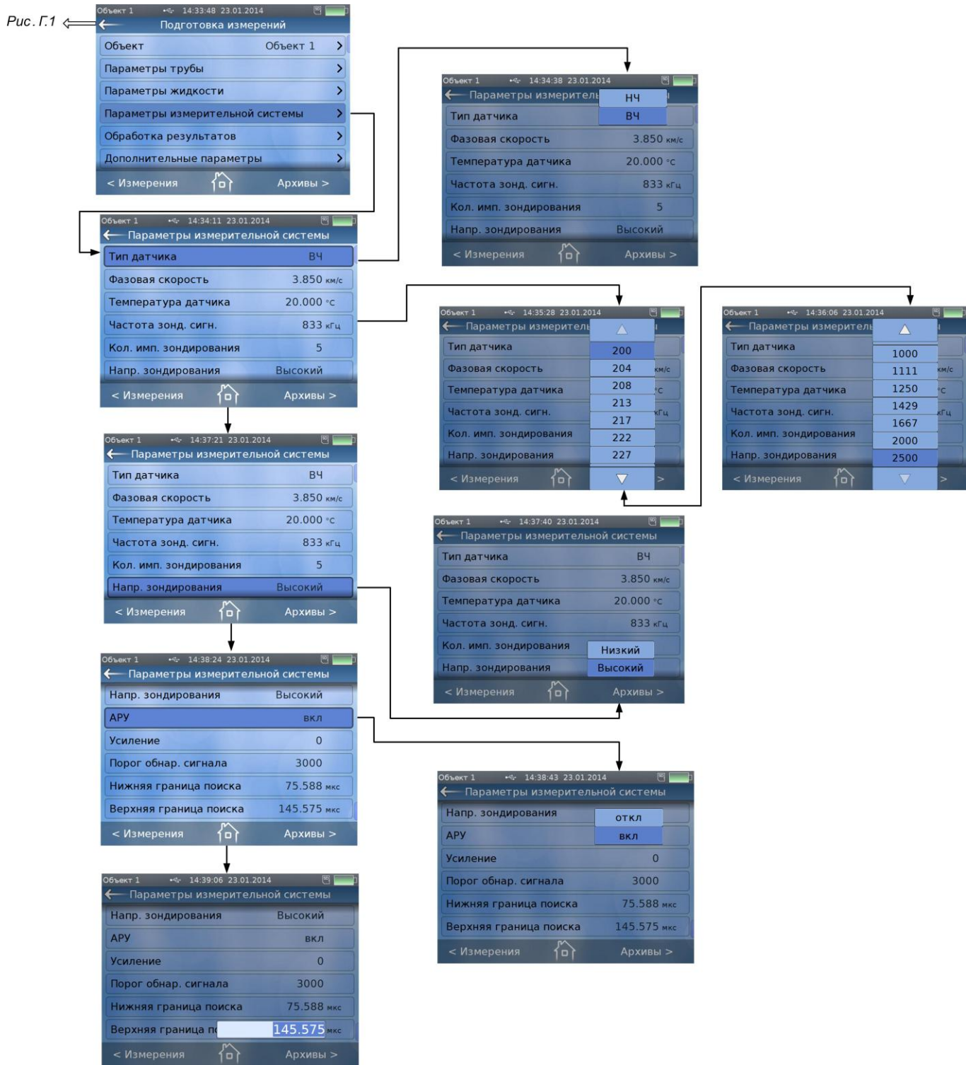
Рис.Г.4. Меню «Подготовка измерений» / «Параметры измерительной системы»
