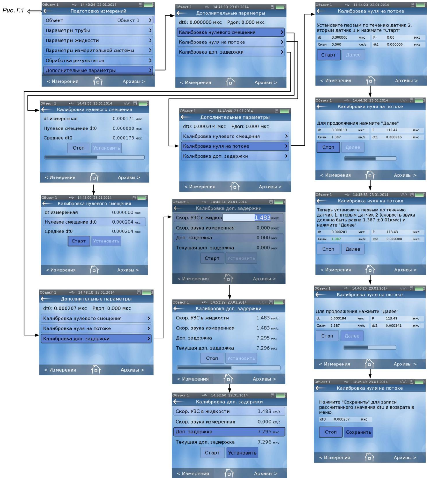
Рис.Г.5. Меню «Подготовка измерений» / «Дополнительные параметры»
