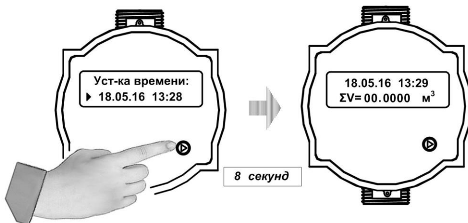
Рис.7. Перевод расходомера в режим эксплуатации.
