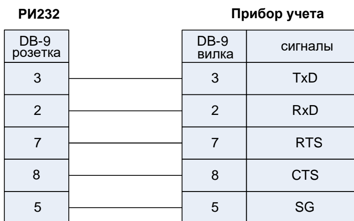
Рис. 4. Подключение приборов СПТ961, СПГ761.
