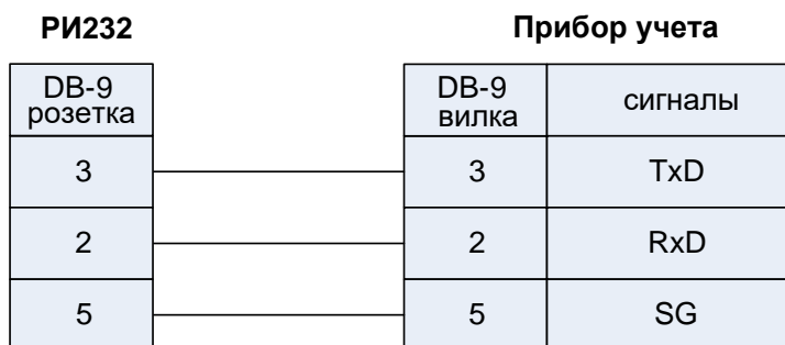
Рис.3. Подключение прибора учета фирмы «Взлет».
