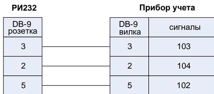
Рис.6. Подключение АПС-45 к адаптеру РИ232.
