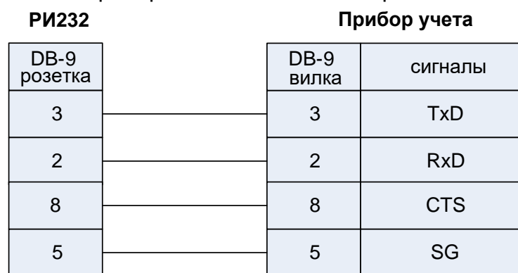
Рис. 7. Подключение ВКТ-5 к адаптеру РИ232.
