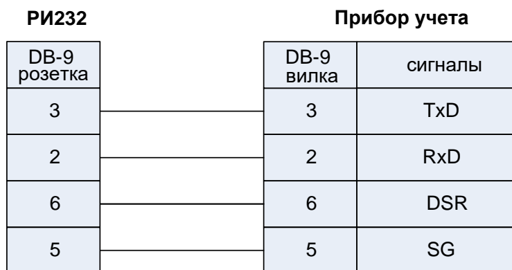
Рис.5. Подключение приборов СПТ943, СПТ943.1.
