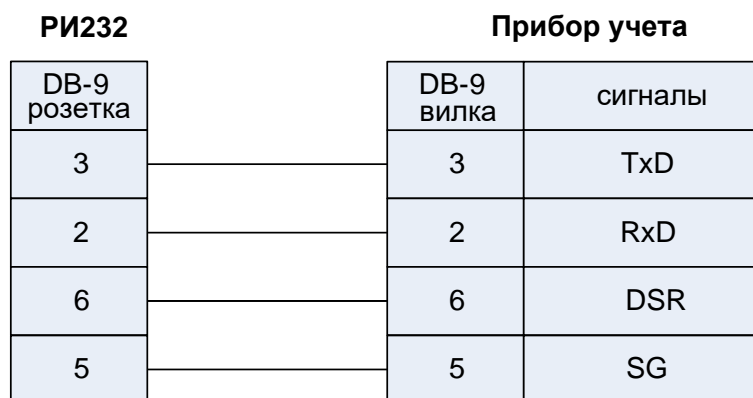
Рис.8. Подключение ВКТ-7 к адаптеру РИ232.
