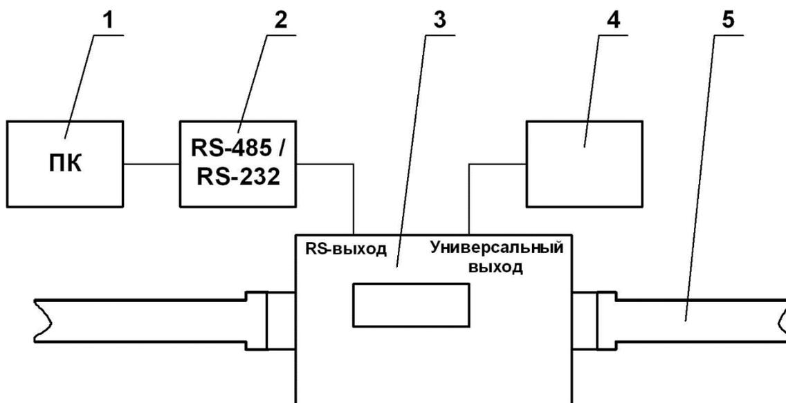
1 – персональный компьютер; 2 – конвертер интерфейса RS-485 / RS-232; 3 – поверяемый расходомер; 4 – частотомер; 5 – трубопровод поверочной установки.
