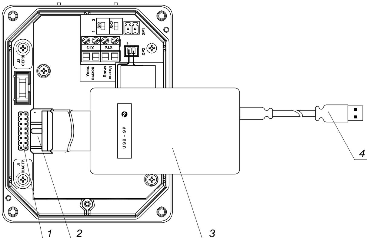
1 – разъем интерфейса UART; 2 – кабельный разъем адаптера; 3 – адаптер «USB-ЭР»; 4 – разъем USB-A.
