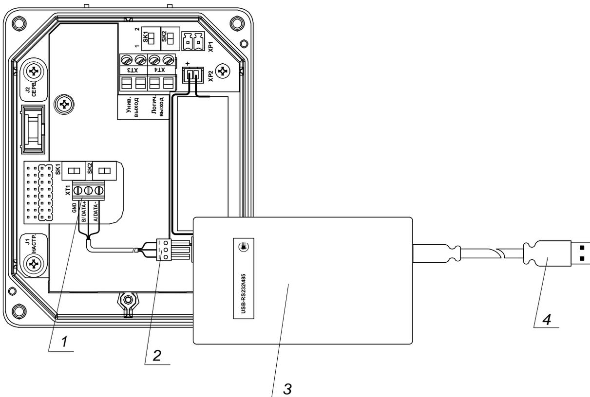
1 – клеммная колодка интерфейса RS-485; 2 – клеммная колодка кабеля связи адаптера; 3 – адаптер «USB-RS232\485»; 4 – разъем USB-A.
