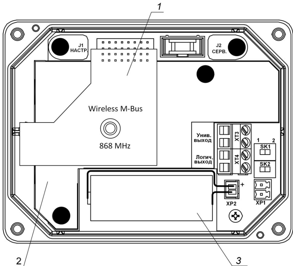
1 – модуль RF Wireless M-Bus 868 МГц; 2 – экран; 3 – батарея 3,6 В;
