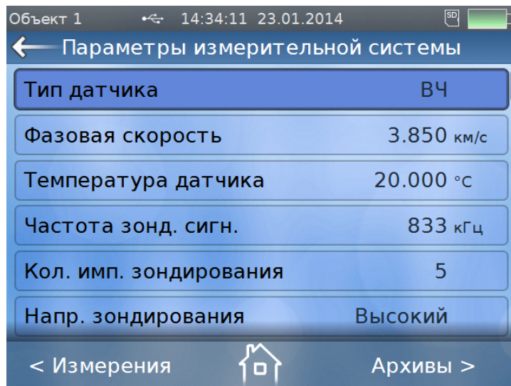
Рис.20. Окно «Параметры измерительной системы»
