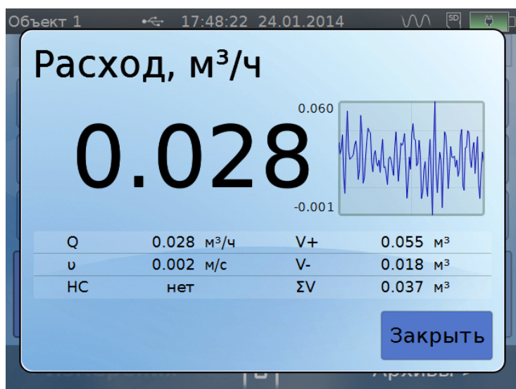
Рис.33. Вид дисплея ВП при укрупненной индикации расхода
