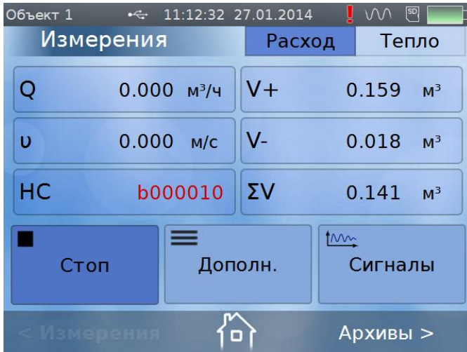
Рис.38. Отображение кода НС в окне «Измерения/Расход»
