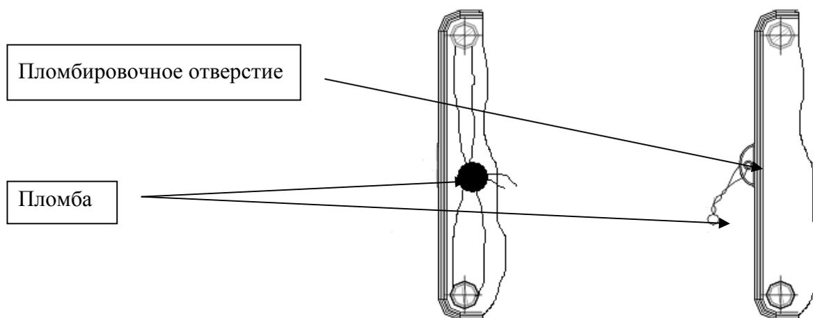
Рисунок 2 - Схема пломбировки расходомеров-счетчиков электромагнитных «ВЗЛЕТ ЭМ»
