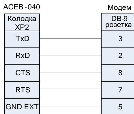
**Рис.10. Подключение АСЕВ-040 к модему.**
