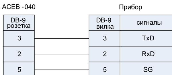
**Рис.3. Подключение прибора по интерфейсу RS-232.**
