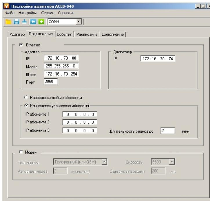
Рис.9. Вкладка «Подключение» программы «Настройка адаптера ACEB-040».
