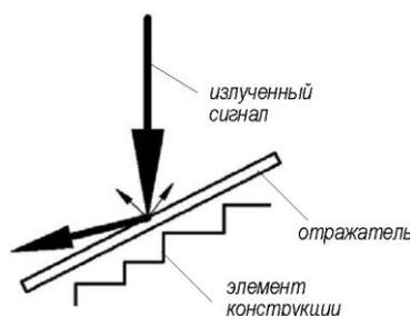
**Рис.12. Применение наклонного отражателя в резервуаре.**
