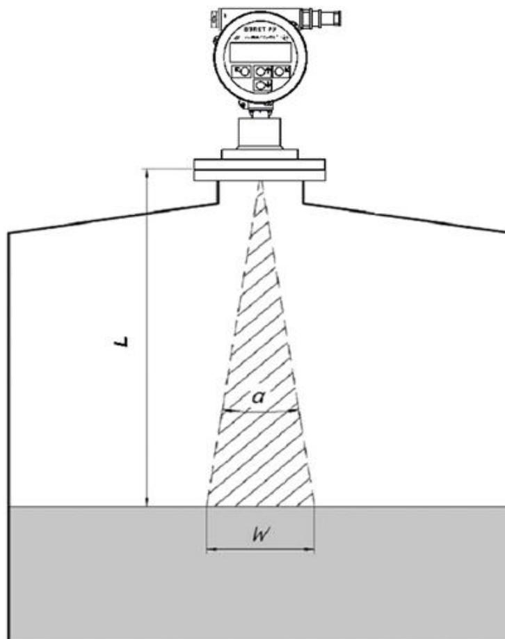
Рис.9. Геометрические параметры зондирующего луча.
