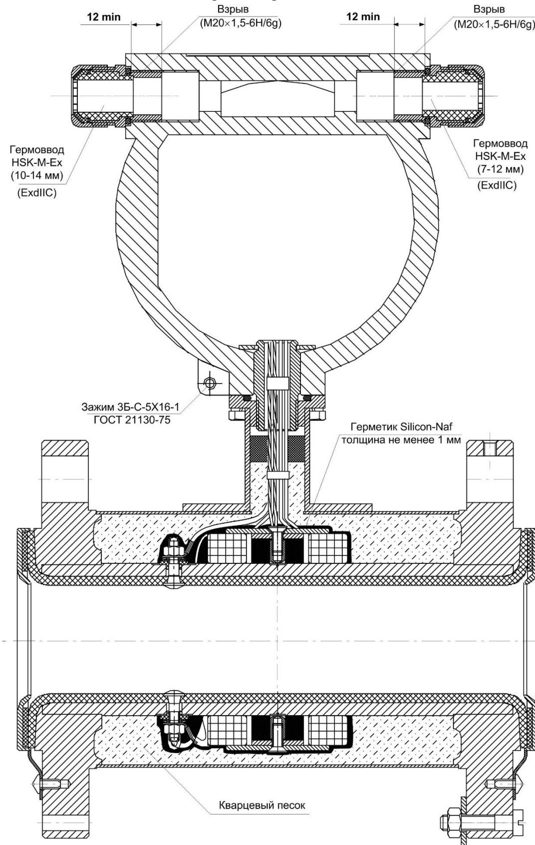
Рис.Б.1 - Взрывонепроницаемая оболочка («d»). Вид спереди
