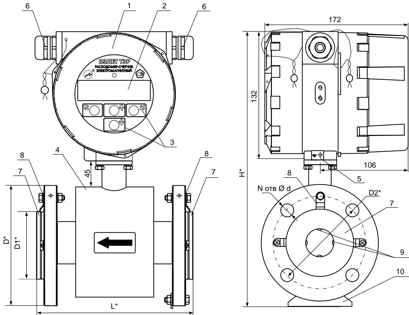
Рис.А.1 - Внешний вид расходомеров фланцеванного исполнения DN20-DN40
