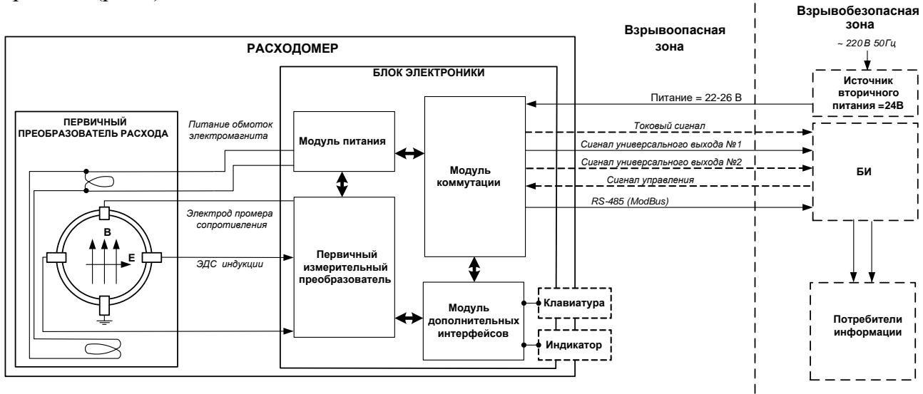
Рис.1 - Структурная схема расходомера
