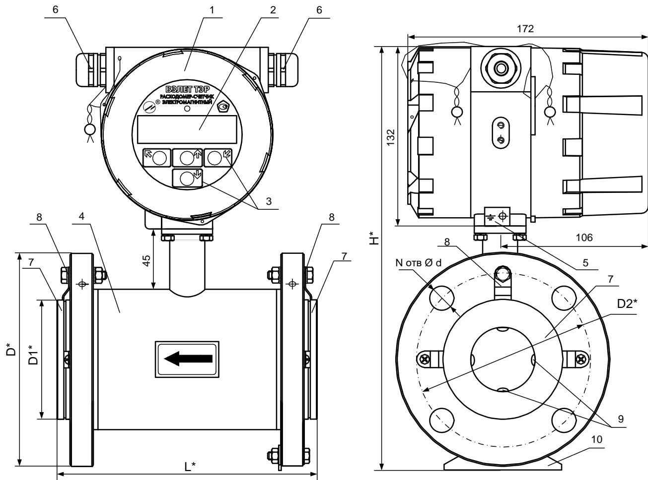
Рис.А.2 - Внешний вид расходомеров фланцеванного исполнения DN50-DN300
