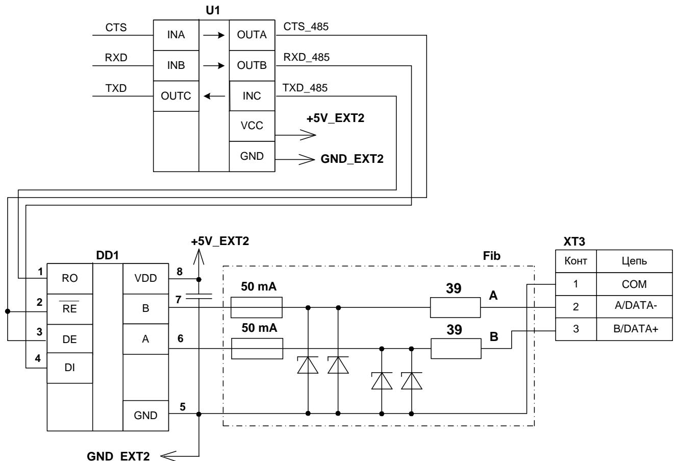
Рис.В.8 - Выход интерфейса RS-485
