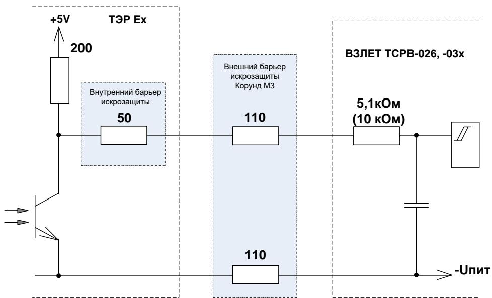
Рис.В.3 - Эквивалентная схема работы на высокоомную нагрузку
