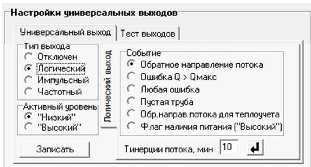
Рис.12. Вид панели «Логический выход».
