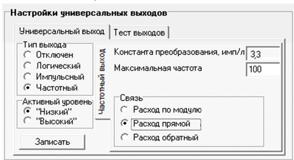
Рис.10. Вид группы «Настройки универсальных выходов» - «Частотный выход».
