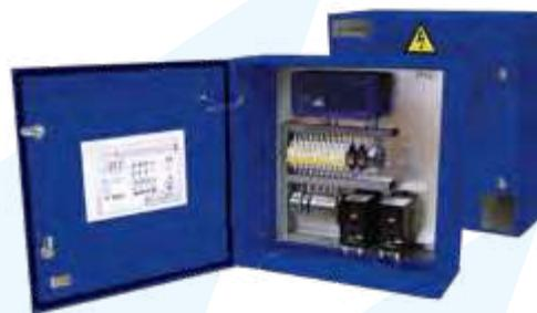
Низковольтные комплектные устройства (далее – НКУ), предназначены для приема и распределения электрической энергии в сетях напряжением до 1000 В частотой 50 Гц с глухозаземленной нейтралью; для размещения в них устройств автоматического управления оборудованием тепловых пунктов, систем отопления и горячего водоснабжения (ГВС), распределительных устройств, устройств защиты, а также для размещения приборов учета расхода жидкостей и тепловой энергии, средств коммутации и связи.
