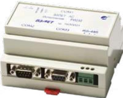
Предназначен для организации обмена данными по интерфейсу RS-232 одного прибора учета с несколькими внешними устройствами, входящими в состав систем диспетчеризации, в том числе, построенных на базе программного комплекса «Взлет СП».
