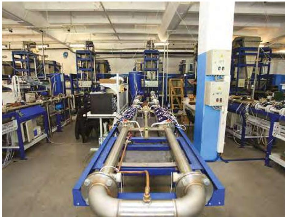
Предназначена для настройки, градуировки, калибровки, юстировки, поверки сличением и других работ по определению метрологических и технических характеристик расходомеров, расходомеров-счетчиков, счетчиков, преобразователей расхода жидкости различного типа и назначения. Установка зарегистрирована в Федеральном информационном фонде по обеспечению единства измерений.
