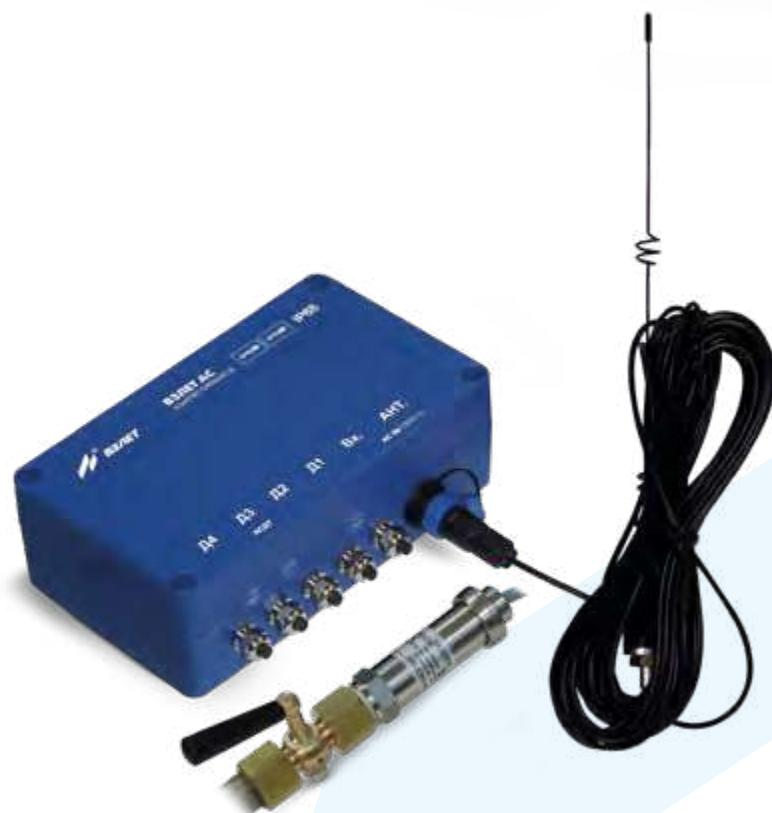
Предназначен для передачи текущих и накопленных данных, а также сообщений о нештатных ситуациях от датчиков давления в диспетчерскую систему, построенную, в том числе, и на базе программного комплекса «ВЗЛЕТ СП».
