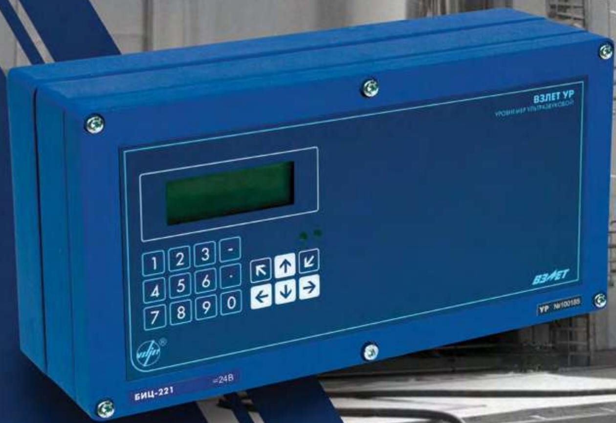
Предназначены для бесконтактного измерения уровня различных жидкостей и дистанции до границы раздела сред, в том числе во взрывобезопасных зонах. Может использоваться в качестве сигнализатора или дальномера. Позволяет определять средний уровень и перепад уровней в двух точках, наполнение и объем жидкости в резервуарах с известными объемными характеристиками.
